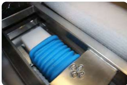
Wasserfeste, gekapselte, silikonbeschichtete Wägezelle
