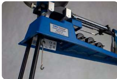
Stativbeine ermöglichen Unterflurwägung
